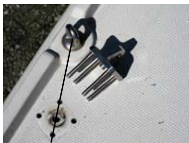
Bild 1: Det nya beslagets fästhål ska ligga i rät linje med toppvantets öglebult.
