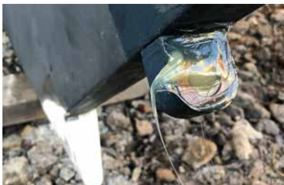
Bild 4. Infettad rodermärla på Pryda, se nederst den lilla roder-skäddan som jag passat på att laga. Den hade brutits av, förmodligen vid en lätt grundstötning och är numera uppbyggd igen och inkapslad i epoxi. Tänk på att rodret och just den lilla roder-skäddan nederst i akterkant av kölen är det känsligaste stället vid en grundstötning.
