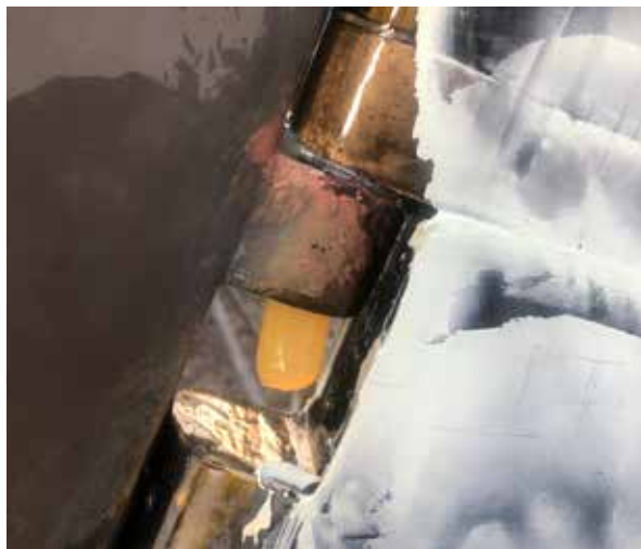
Bild 5. Primulas roder påhängt igen. Det tjocka fettets trycks ut som en korv och tas enkelt bort innan den lilla låsklacken monteras tillbaka.
