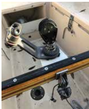
Bild 2. Skotarmskonsoller i svetsad/bockad aluminium.
