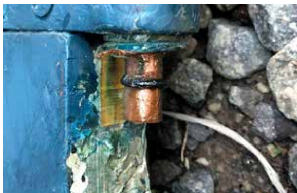
Bild 2. Samma tapp med ny O-ring. Men kommer det intakta spåret på andra sidan tappen hålla O-ringens på plats när rodret hängs på igen?
