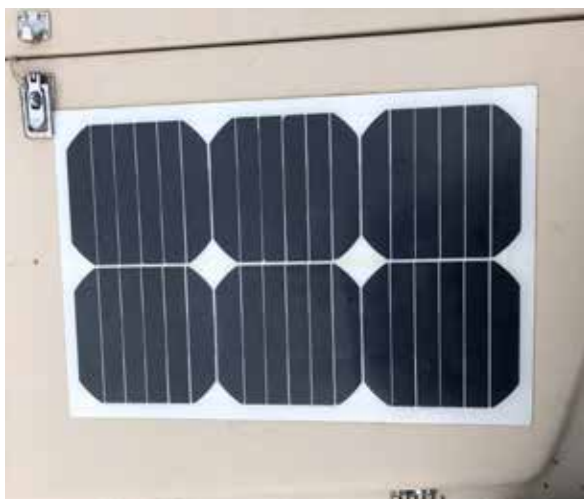
Bild 1. Liten, smidig solcell som lätt limmas på en av akterluckorna. Tyvärr vet jag inte fabrikatet då jag köpte denna och en likadan till av en kille som sålde dem på IF-båtförbundets salutorg på webbsidan.
