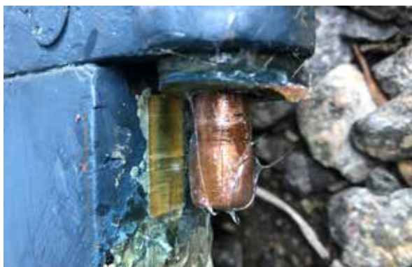
Bild 1. Prydas mellersta rodertapp med den slitna sidan i bild, spåret till O-ringens knapp är grunt och syns knappt.
