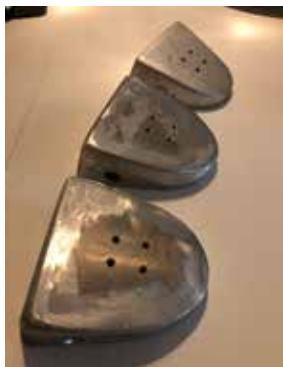
Bild 2. Skotarmskonsoller i svetsad/bockad aluminium.
