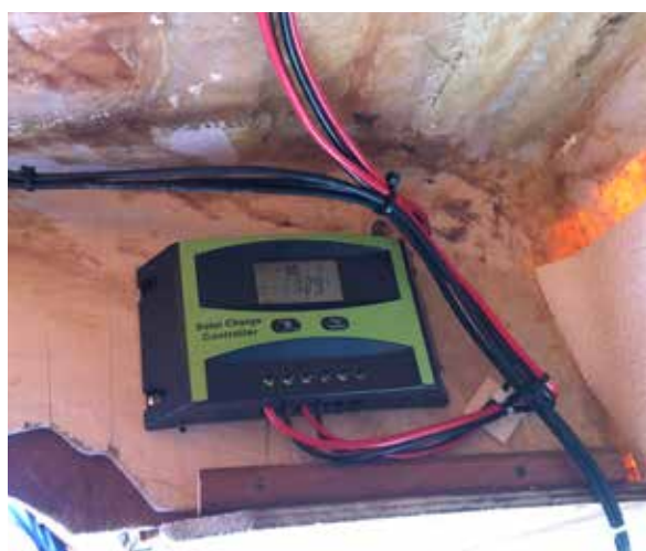
Bild 3. En regulator är bra om man är rädd om sitt batteri. Den här är bra då man kan (om man kryper in i stick-kojen alltså) se både laddningsström från cellen samt batteriets spänning. Om batteriet håller 12,7 volt är det fulladdat.
