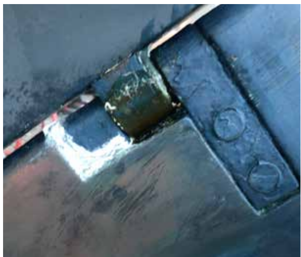
Bild 7. Prydas roder påhängt med monterad låsklack. På Pryda limmas klackarna med Sikaflex eller liknande.
