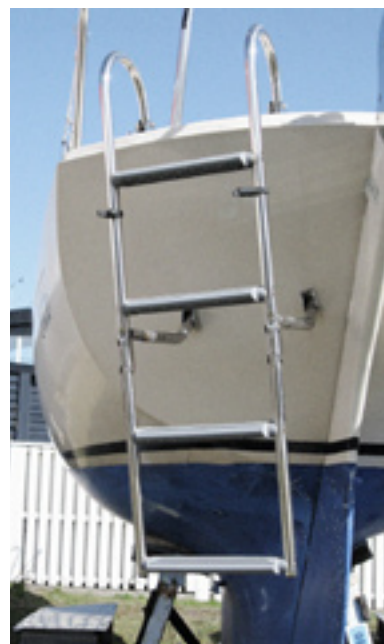
En steg som är lätt att klättra upp på för en nödställd. Den har rejäla handtag över däck som förenklar ombordstigningen.
