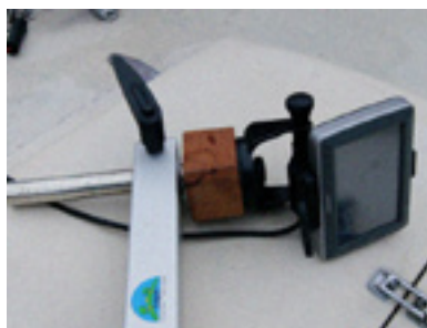
Lagunans arm, röret är 25 mm i diameter, samt GPS med fot
