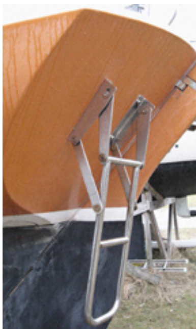
En steg monterad för långt ner hänger för djupt ned i vattner, vilket gör att det blir ganska svårt att ta sig upp på däck.
