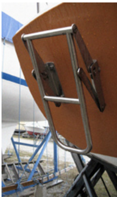
En vanlig typ av steg man ofta ser på IF-båtars akterspegel. Den är ganska svår att lösgöra, eftersom den måste tryckas uppåt.
