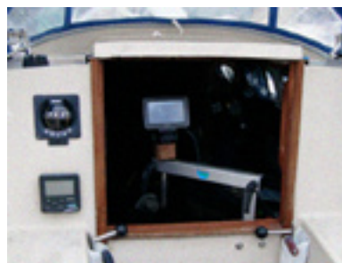
Plottern inne under rufftaket. Ingen risk att skoten fastnar samt regn- och solskyddad. Armen är placerad så lång styrbord som möjligt.
