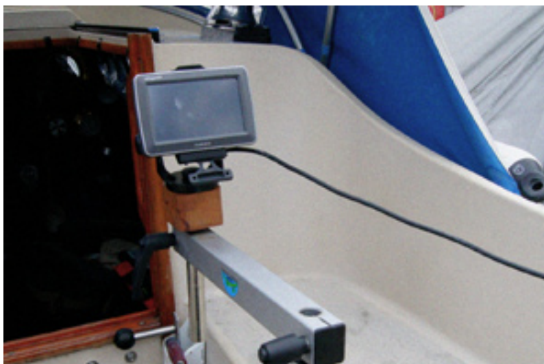
GPS monterad i sittbrunnens Lagunafäste. Svängbar, men en liten risk att skoten kan hakar fast. Detta läge används vid ensamsegling.
