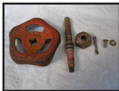
Alla lösa smådelar. Från vänster – vred, ventilaxel, ventilhusets yttre mutter, saxsprint, fästskruv för vred och bricka under fästskruv.
