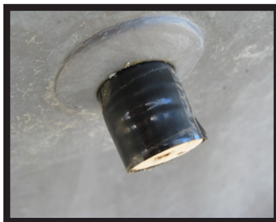
Vinkork, omvird med litet eltejp för att den ska sitta bra med presspassning i självlänsens bordgenomföring.
