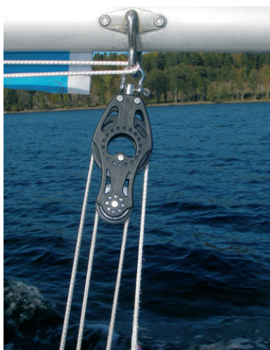
Skotets hölje är avskalat till precis innan det når skotblocket.
