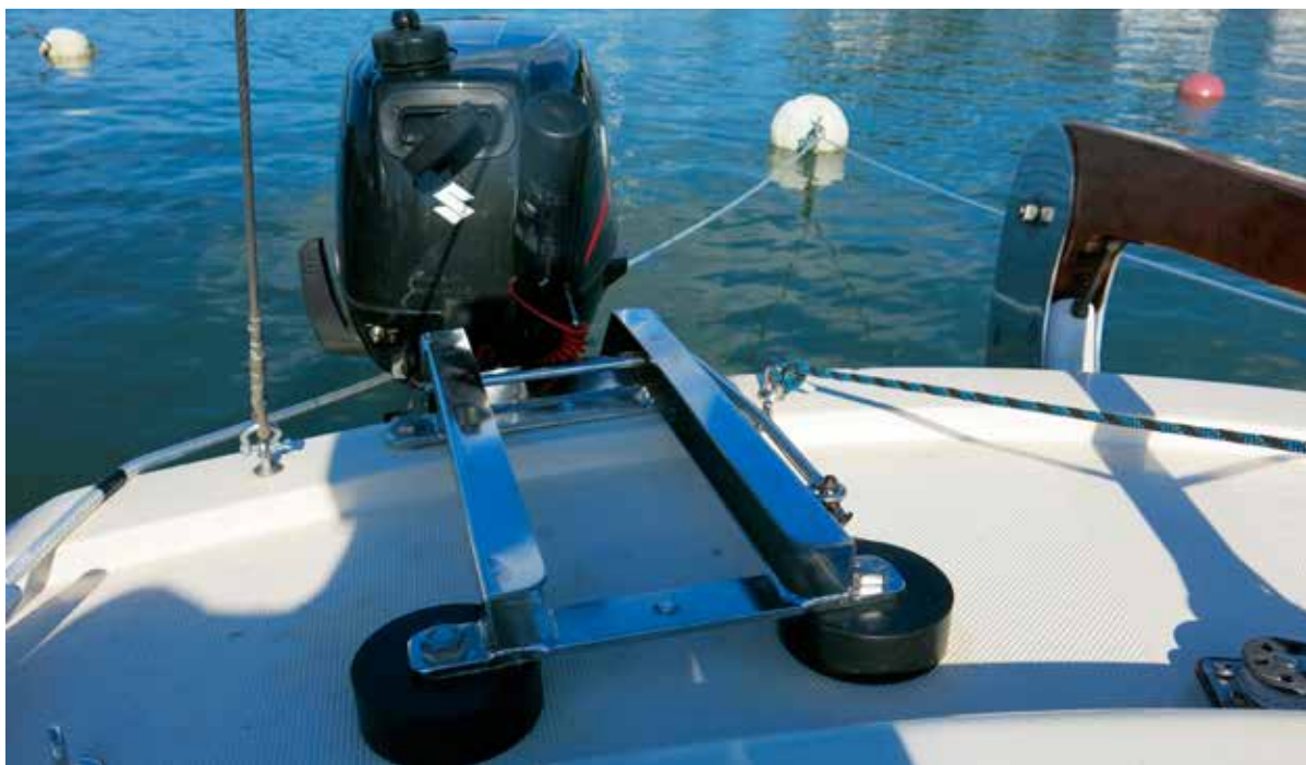
Motorfästet monterat på fotlisten och med "hockeypuckar" för att få fästet horisontellt monterat.
