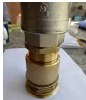
2. Kranen settes på.
