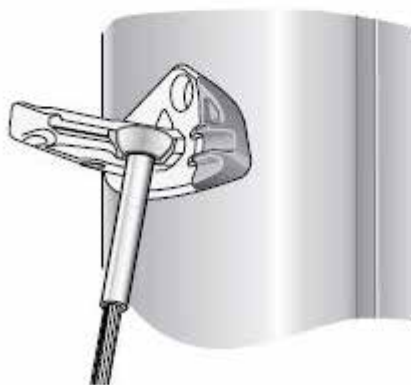
Spridarfäste för undervant med stem ball-ändstycke (från Seldéns)
