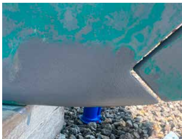
De efter slipning exponerade glasfiberytorna på skäddan får sig en egen omgång av epoxilager innan slutlig bottenmålning med antifouling.
