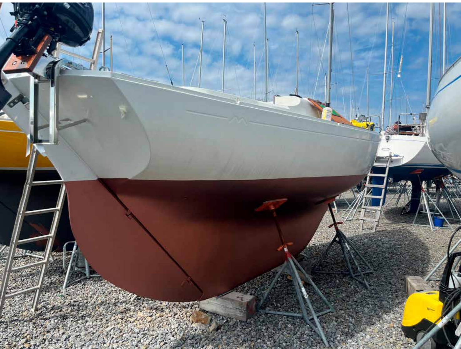
Avslutningsvis två lager VC 17, allt under vattenlinjen är nu bättre än när båten var varvsny.
