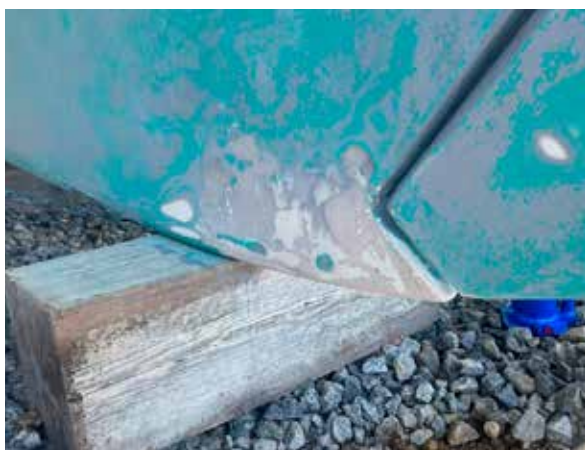
Den nya skäddan formas, spacklas och slipas slutligen till sin exakta originalform.
