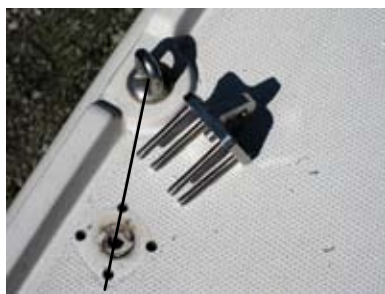
Bild 1: Det nya beslagets fästhål ska ligga i rät linje med toppvantets öglebult.
