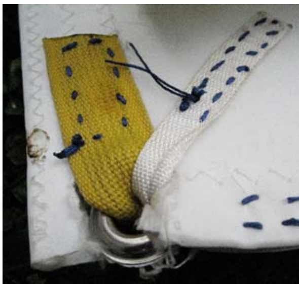
Den provisoriska lagningen av halsringen.
