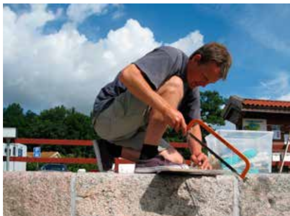
David fick såga ett större hål i plattan som han hade instoppad runt motorns rigg och över motorbrunnen för att hindra att vatten slog in i akterutrymmet.
