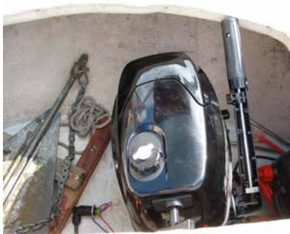
Den nya motorn gick precis ner i brunnen och fick plats under akter- luckan, även om tanklock och handtag blev litet tilltryckta när man stängde luckan. Alla reglage kunde också nås utan problem.
